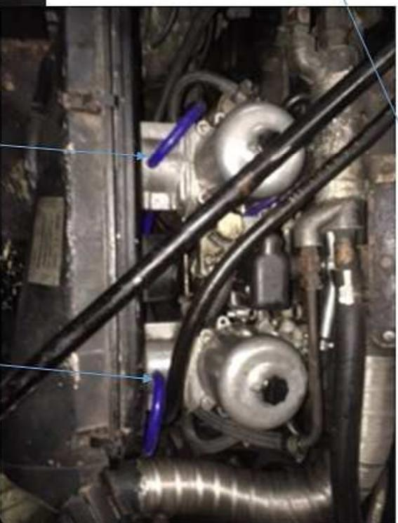
Diese Schläuche verlaufen von diesen beiden Ausgängen von links und rechts an den Schalter im Luftfilter (Bild links)
