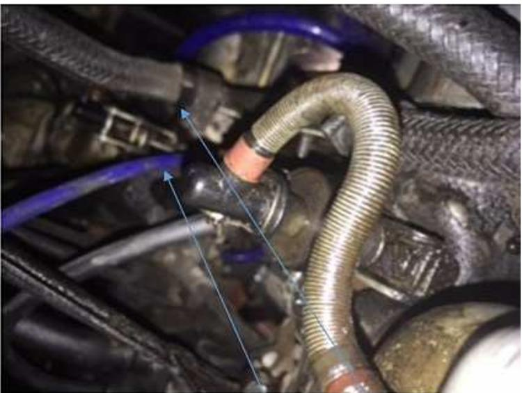
Bild rechts: Anschlüsse von unten von der Einheit hinter den Vergasern. Ein dicker Auslass und zwei dünne. Dicker geht zum Startvergaser
